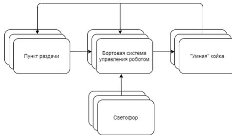
Рис. 1. Структура мультиагентной системы управления.
