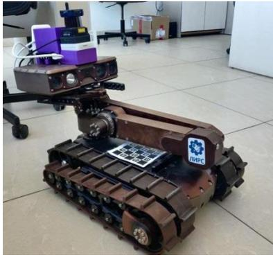
Рис. 2. Гусеничный робот Сервосила Инженер.
