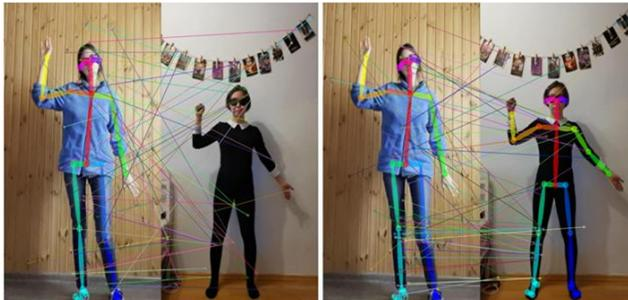
Рис. 7. Прямое сопоставление поз без использования скелета (106 совпадений) и сопоставление на основе скелета (101 совпадение).
