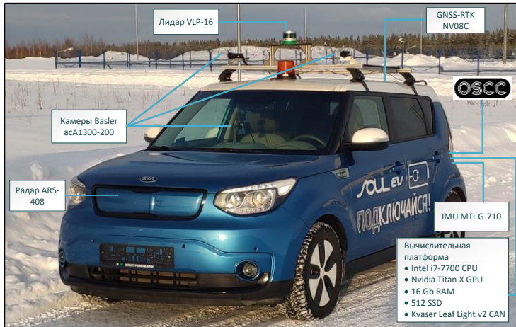
Рис. 1. Беспилотный автомобиль со схемой установленного оборудования.
