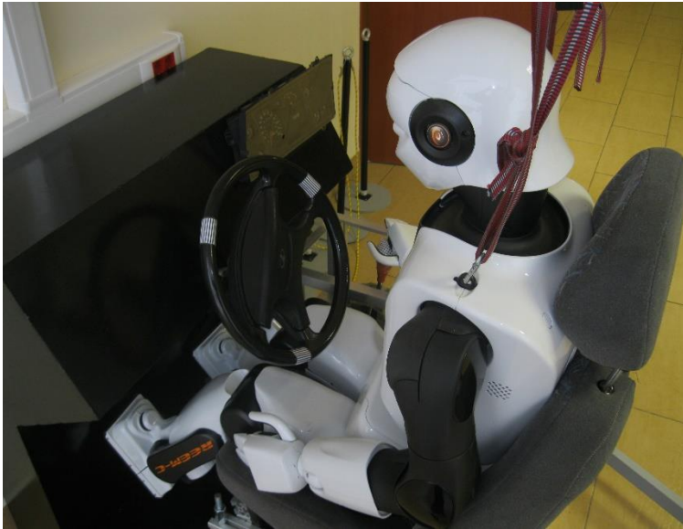
Рис. 1. Общий вид макета рабочего места водителя с антропоморфным роботом REEM-C
