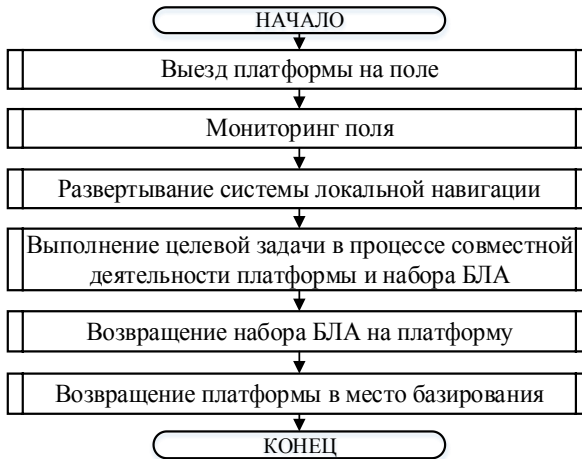
Рис. 1. Алгоритмическая модель совместной работы подвижной платформы и набора БЛА
