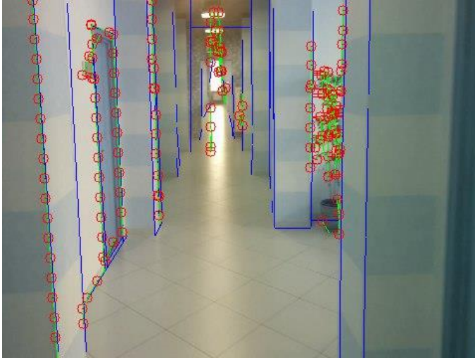
Рис. 1. Результат поиска границ на изображении и их сопоставления с границами, полученными из смоделированного изображения (синие линии – ребра из моделируемого изображения, зеленые линии и красные круги – найденные на изображении с камеры)
