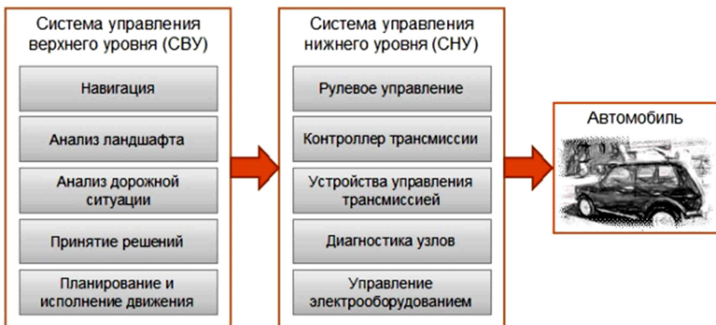
Рис 6. Система управления робота-автомобиля.
