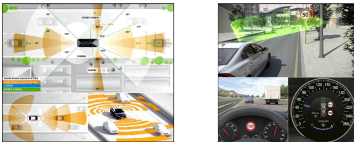
Рис.3. Система ближнего и дальнего "зрения" машины. ИИ и зрение.
