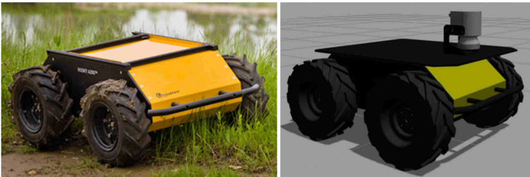
Рис. 3. Робот Clearpath Husky: фото (слева) и модель из Gazebo (справа).
