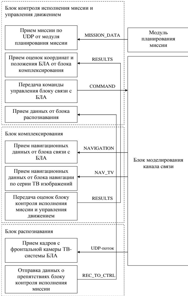
Рис.2. Схема взаимодействия блоков управления, распознавания и комплексирования с другими блоками программного комплекса
